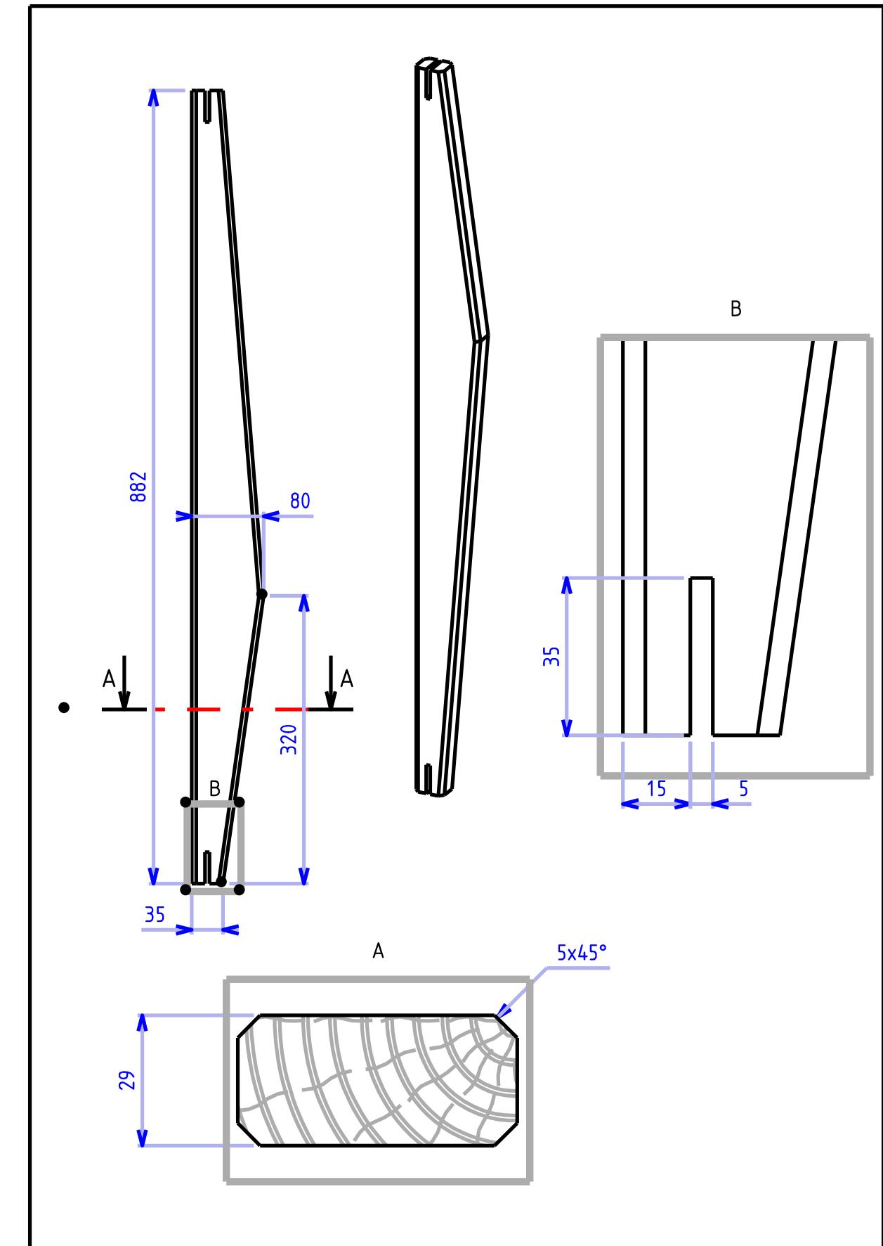
Plan d'un module de garde corps
